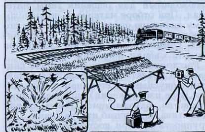
Рис. 3. Схема масштабного-пространственного совмещения фона и происходящего на переднем плане взрыва при съёмке методом перспективного совмещения.
