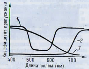
Типичные кривые спектрального пропускания светофильтров — двусторонних (1), односторонних (2) и для подгонки спектральных кривых излучения (3).
