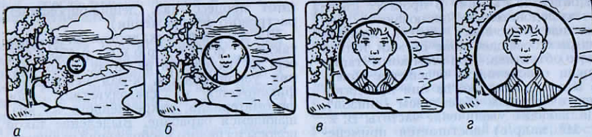
Последовательные фазы центрального вытеснения изображения: а — появление нового изображения в центре кадра; б, в, г — постепенное увеличение изображения и вытеснение первоначального.
