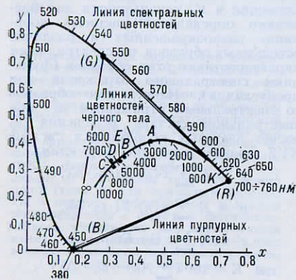
Рис. 2. График цветностей x, y системы XYZ и цветовой треугольник системы RGB: A, B, C и D — точки цветности стандартных источников освещения MКО; E — точка цветности равноэнергетического белого цвета (опорная цветность системы XYZ).
