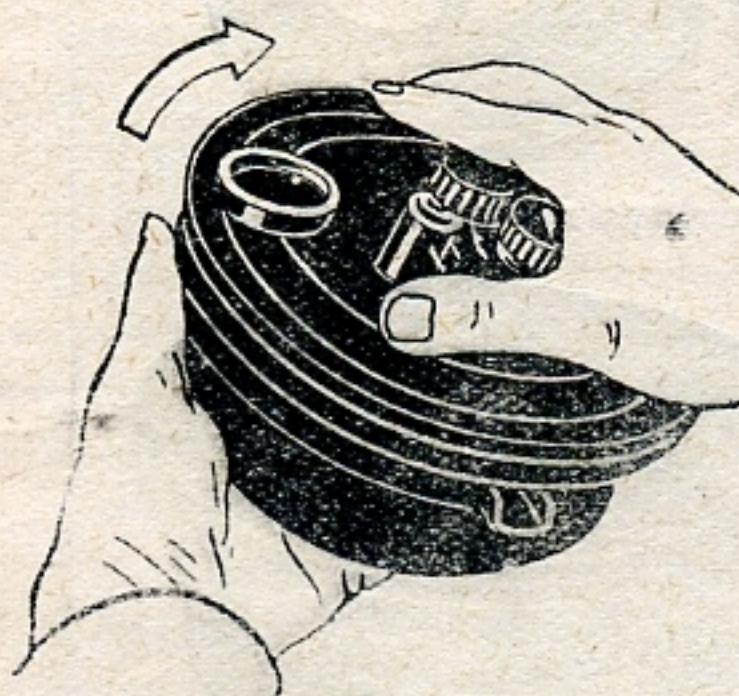
Рис. 54. Поворачивание крышки бачка «ФЭД» после перемотки пленки
