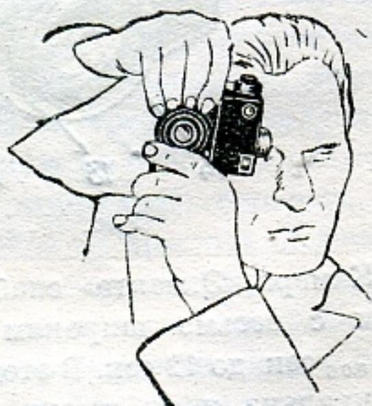
Рис. 24. Визирование с помощью видоискателя
