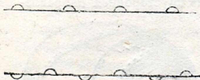
Рис. 35. Расположение выпуклостей на ленте «Коррекс»: в верху — одностороннее, внизу — двустороннее
