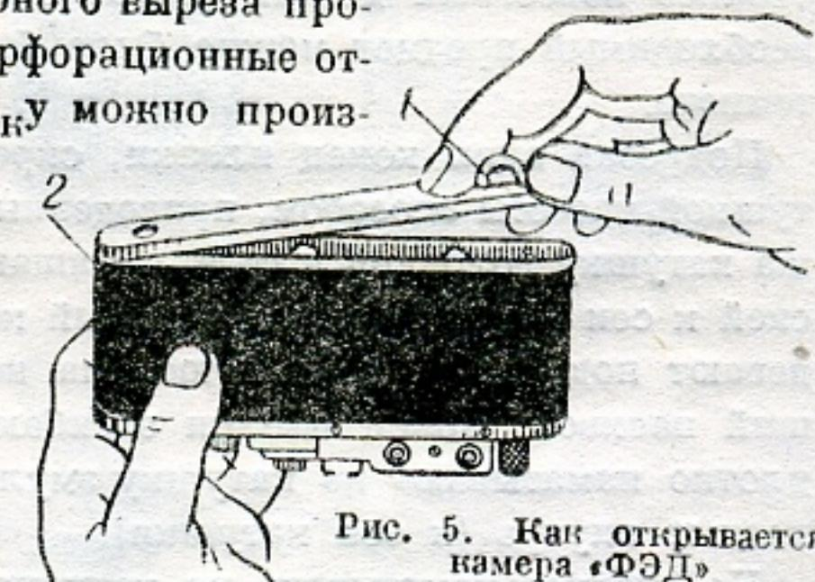
Рис. 5. Как открывается камера «ФЭД»
